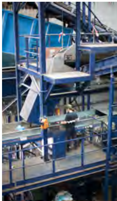
Electroimant que separa les llaunes de ferro de la resta d'envasos.
