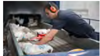
Triage manual dels films després de l'aspirador.
